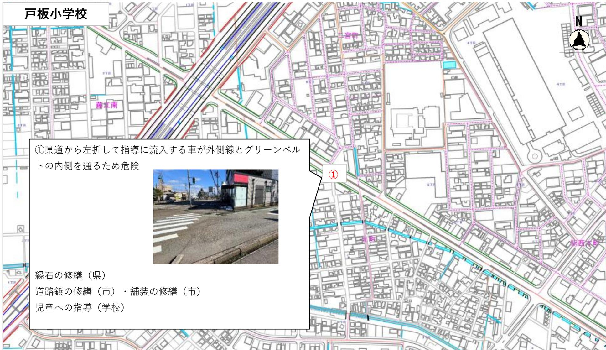
①県道から左折して指導に流入する車が外側線とグリーンベルトの内側を通るため危険
